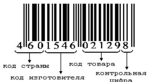
Последний информационный знак символа кодирует контрольный знак. Так символ EAN-13 содержит только 12 информационных знаков символа, но кодирует 13 цифр данных (включая контрольный знак). Сумма модулей (штрихов) знака определяет его паритет (четный или нечетный). Пример символа штрихового кода EAN-13 приведен на рисунке 5.
