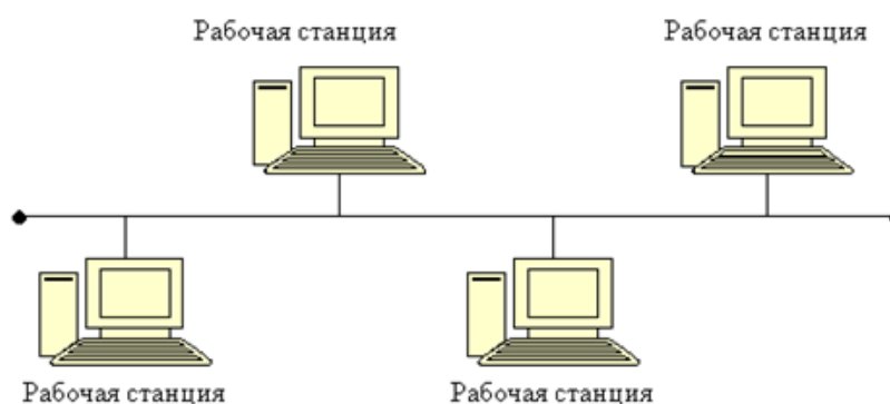
Рис. 1. Сеть с шинной топологией
